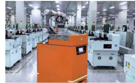
Die Bonder Loading & Unloading
